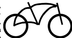
On voit apparaître des cadres composés de tubes complètement cintrés qui font montre d'une souplesse remarquable : c'est logique puisque le bon vieux principe de la triangulation est violé, les tubes travaillent en flexion. On découvre même que le sacro-saint cadre triangulé avait une barre bien ennuyeuse qui obligeait à l'enfourcher : supprimons cette barre et nous aurons les vélos à "accessibilité améliorée". Quid de la tenue de ces "jeunes cadres" dans le temps ?
